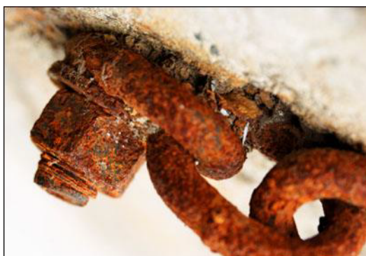
Phénomène de rouille sur de l'acier (alliage de fer et de carbone)
