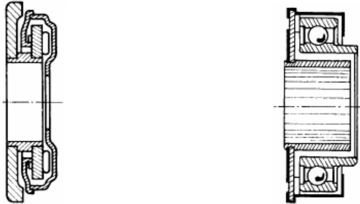
FIG. 18 – Butée à aiguille et à billes
