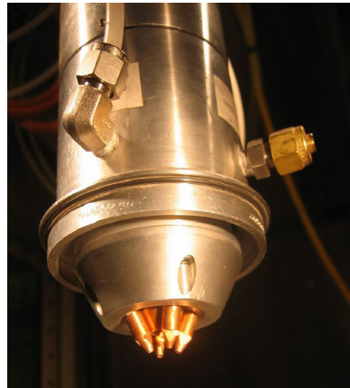
Figure I.5 – Buse d'origine utilisée sur la machine Optomec LENS 850R
