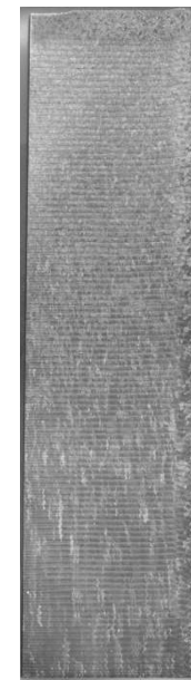
Figure V.23 – Surface polie et attaquée d'une partie du mur réalisé avec la paramétrie D (Maisonneuve, 2008)
