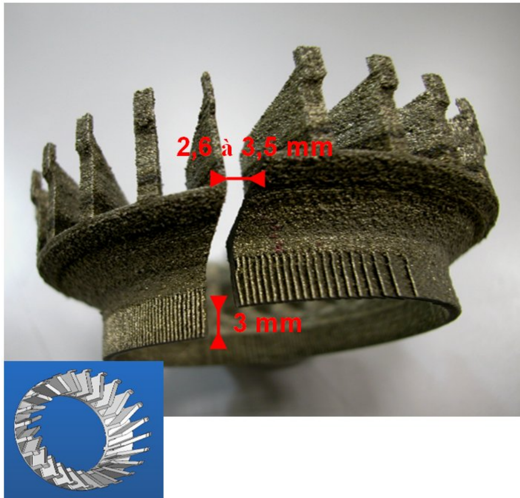
Figure II.12 – Mise en évidence des contraintes résiduelles dans la velle d'injection en IN718 de Snecma après une découpe au fil par électroérosion
