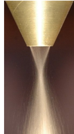
Figure I.6 – Buse coaxiale tronquée utilisée sur la machine Optomec LENS 850R
