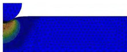
**Figure 6:** Modélisation par éléments finis 2D axi-symétrique d'un essai d'indentation d'une plaque sandwich.
