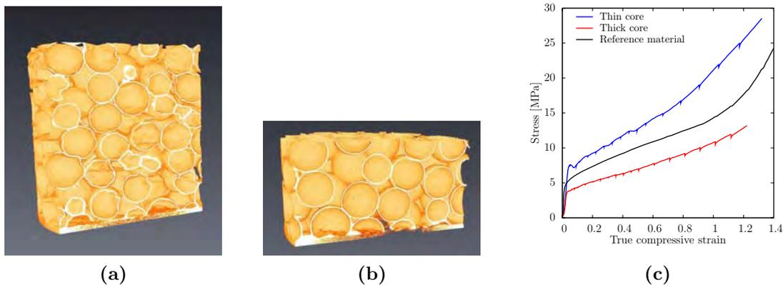
**Figure 3:** *a,b-* Observation par tomographie R-X de structures sandwich d'épaisseur de cœur fine (a) et épaisse (b). *c-* Courbes contrainte-déformation d'essais de compression sur le matériau cœur issu de sandwichs d'épaisseur de cœur variables et comparaison au comportement du matériau n'ayant pas subi de procédé d'intégration dans une structure.
