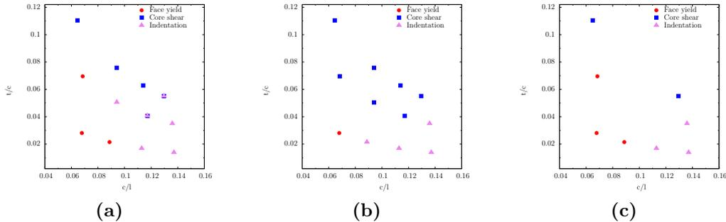
**Figure 17:** Carte des modes d'endommagements des structures sandwichs en fonction de l'épaisseur de peau normalisée ( $t/c$ ) et de l'épaisseur de cœur normalisée ( $c/L$ ) pour les expériences (a), les modèles analytiques (b) et pour les simulations par éléments finis (c).
