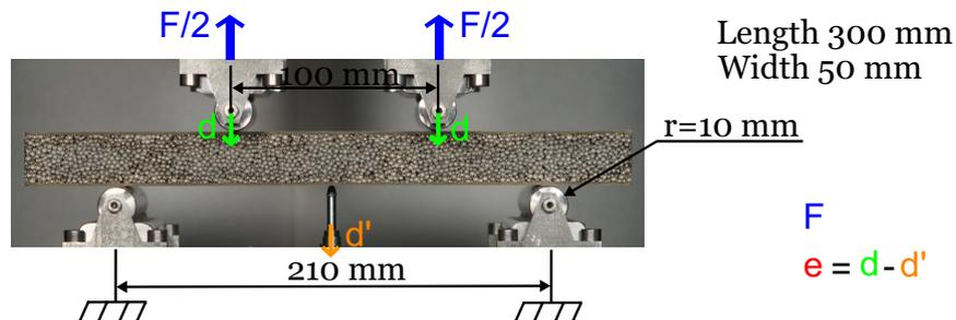
**Figure 13:** Essais de flexion 4-point d'une poutre sandwich.
