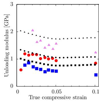
**Figure 19:** Comparaison des expériences (gros motifs en couleurs) et des modèles (petits motifs noirs) avec correction de la taille de col et de la loi de cisaillement.
