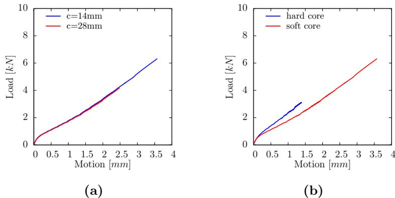
**Figure 8:** Simulations par éléments finis de l'indentation de plaques sandwich. **a-** A propriétés mécaniques du cœur équivalentes, deux structures avec des cœurs d'épaisseurs variables ont la même réponse à l'indentation. **b-** A épaisseur de cœur identique, des propriétés mécaniques de cœur variable entraînent une modification de la réponse du même ordre de grandeur que celle observée sur les expériences.
