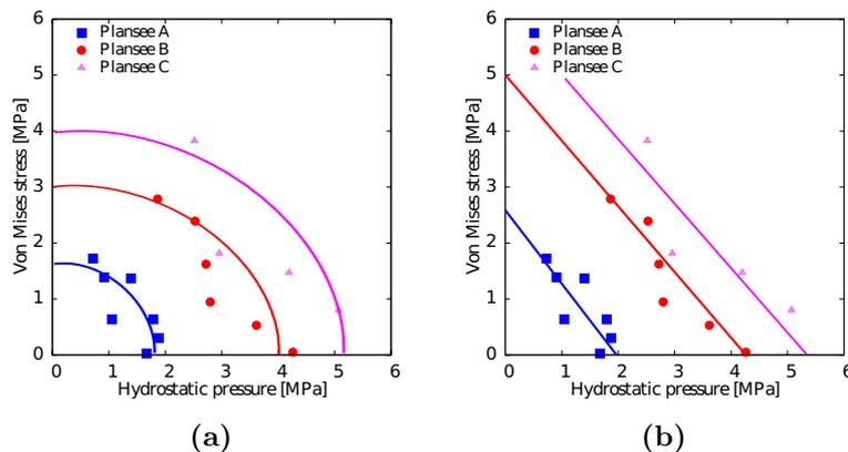
**Figure 22:** Surfaces de plasticités selon la densité initiale des mousses. Les critères elliptiques (a) et de Drucker-Prager (b) sont tracés.
