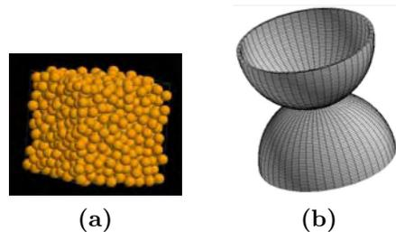
**Figure 13:** Les deux échelles de la méthode couplée DEM-EF.
