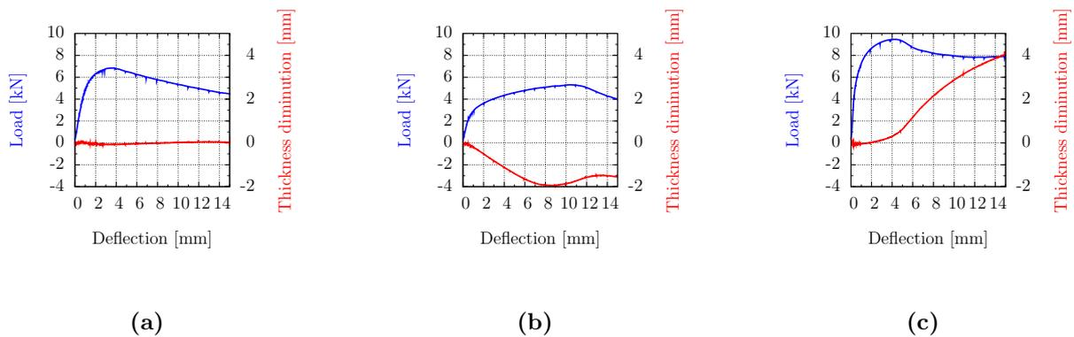
**Figure 16:** Signature des modes d'endommagements des structures sandwichs grâce à l'évolution de la réaction  $F$  et du paramètre d'épaisseur  $e$  avec la déflexion : (a) cisaillement du cœur, (b) plastification des peaux, (c) indentation.
