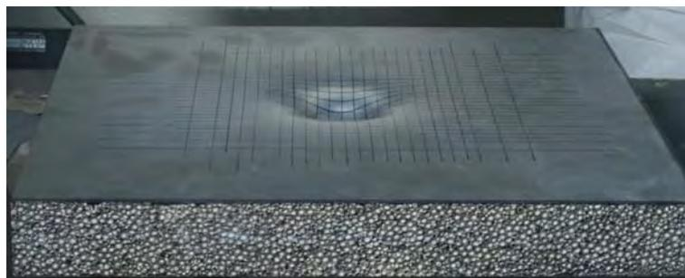
**Figure 5:** Essais d'indentation d'une plaque sandwich.
