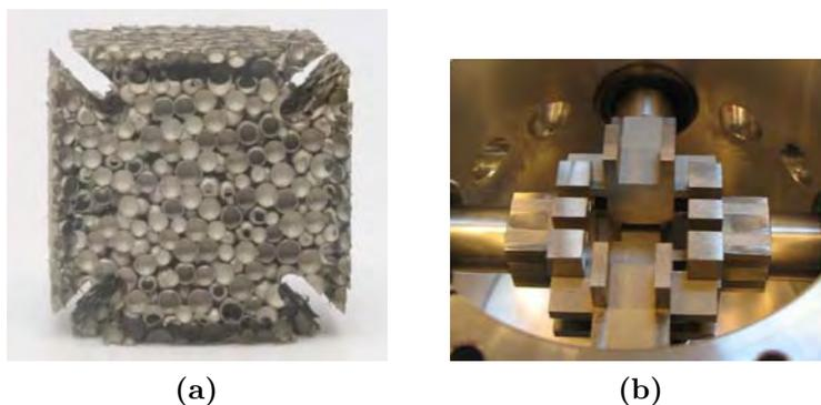
**Figure 20:** Échantillon et plateaux pour l'essai “3 axes”.
