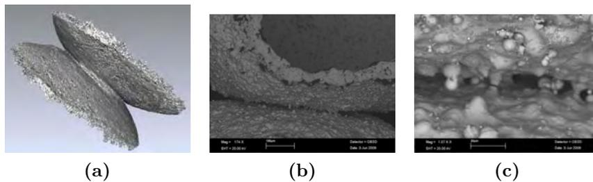
**Figure 3:** Comparaison des observations d'un col par tomographie aux rayons X (a) et par microscope électronique à balayage (a- grossissement  $x174$ , b- grossissement  $x1070$ ).
