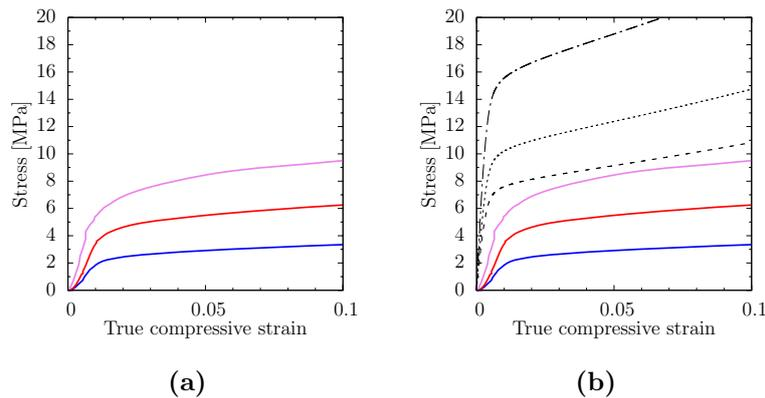
**Figure 18:** Comparaison des expériences (traits pleins en couleurs) et des modèles (traits pointillés noirs) sans correction (a) et avec correction de la taille de col et de la loi de cisaillement (b).
