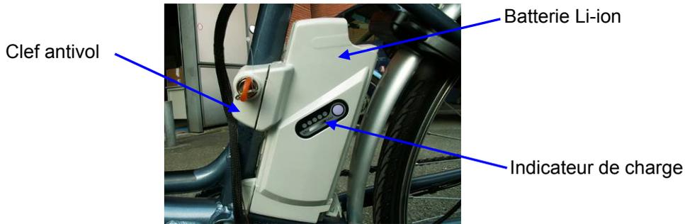
La charge de la batterie est indiquée précisément en appuyant sur le bouton de mesure de charge sur le côté de la batterie. Les 5 leds à côté de celui-ci s'allumant proportionnellement à la charge : 5 voyants allumés signifient une charge maximale 1 seul signifiant une charge faible et la nécessité de recharger la batterie
