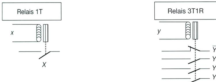
Le schéma suivant montre un relais utilisé en commande de moteur triphasé.
