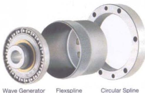
Le Flexspline a deux dents de moins que le Circular Spline. Il est déformé par le Wave Generator elliptique, et engène la denture du Circular Spline aux extrémités du grand axe de l'ellipse. Dès que le Wave Generator est entraîné, la zone d'engrènement se déplace avec le grand axe de l'ellipse.
