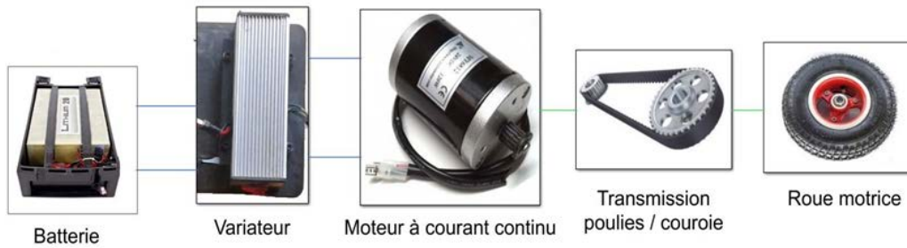
Figure 4 : Chaine de puissance du skateboard
