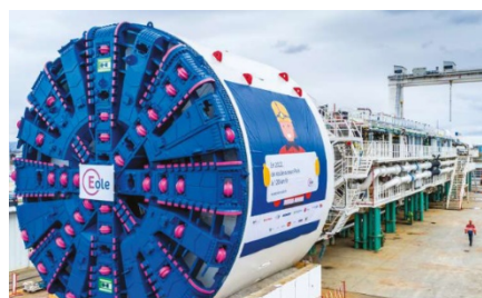
Figure II-1 : Foreuse du tunnelier – Types de tunnel ferroviaire
