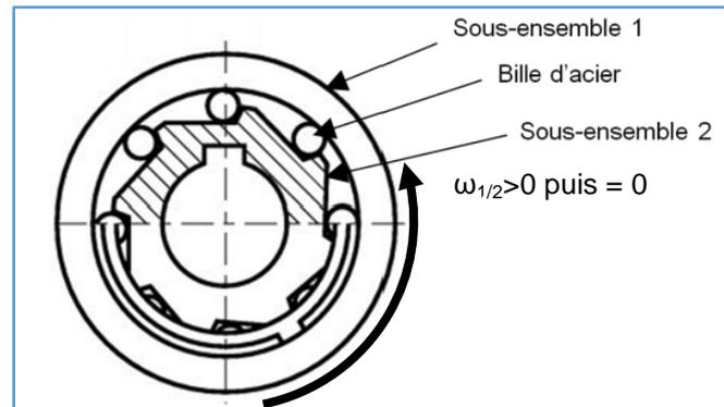
Les aimants liés au sous ensemble 1 deviennent donc immobiles par rapport à la fourche du vélo, ce qui provoque la rotation de la roue électrique. Lorsque l'assistance est désactivée, ou que le vélo va à une vitesse supérieure à  $25 \text{ km}\cdot\text{h}^{-1}$ , les bobines et les aimants sont magnétiquement liés, donc le sous-ensemble 1 tourne dans le sens anti-trigonométrique (horaire) par rapport au sous-ensemble 2 ce qui a pour effet de libérer les billes de la roue libre.
