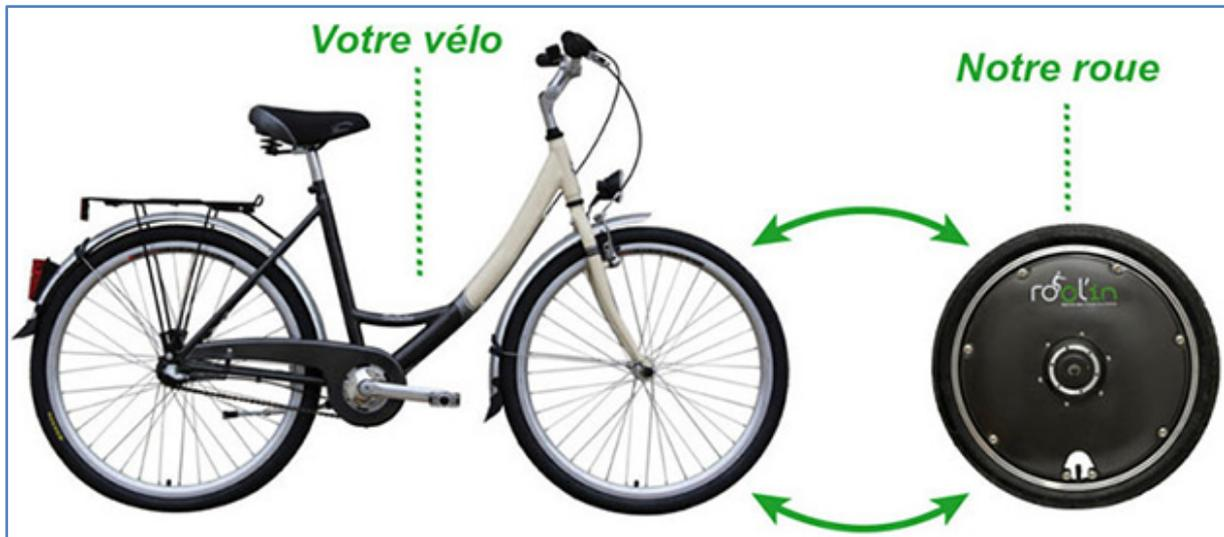
Le système Rool'in se compose d'une roue avant dont le moyeu contient un moteur électrique, des batteries et un capteur de vitesse, d'un détecteur de pédalage, d'un détecteur de freinage et d'une console électronique. Dès qu'un mouvement de pédalage est détecté, la console électronique transmet, par WiFi, l'ordre au moteur électrique de se mettre à tourner.
