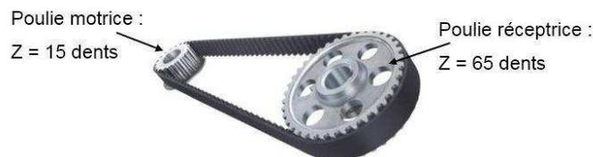
**Figure 4 : Caractéristiques du système poulies / courroie**
