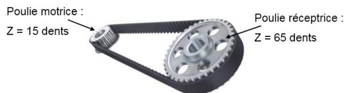
Figure 4 : Caractéristiques du système poulies / courroie
