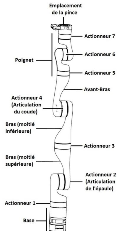
Figure 2-1 : composants principaux du bras robotisé
