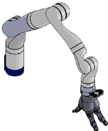
Le bras robotisé d'assistance (figure 1-2) est un bras poly-articulé 7 axes. Une main artificielle, que l'on dénommera pince, est fixée à son extrémité afin de manipuler les objets.
