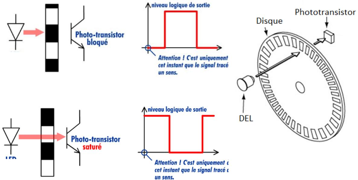
Figure 2-3 : fonctionnement d'un codeur optique incrémental
