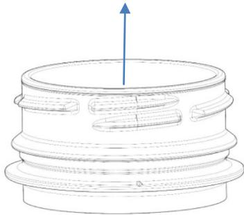
Figure 1-3 : représentation 3D d'une bague de bouteille
