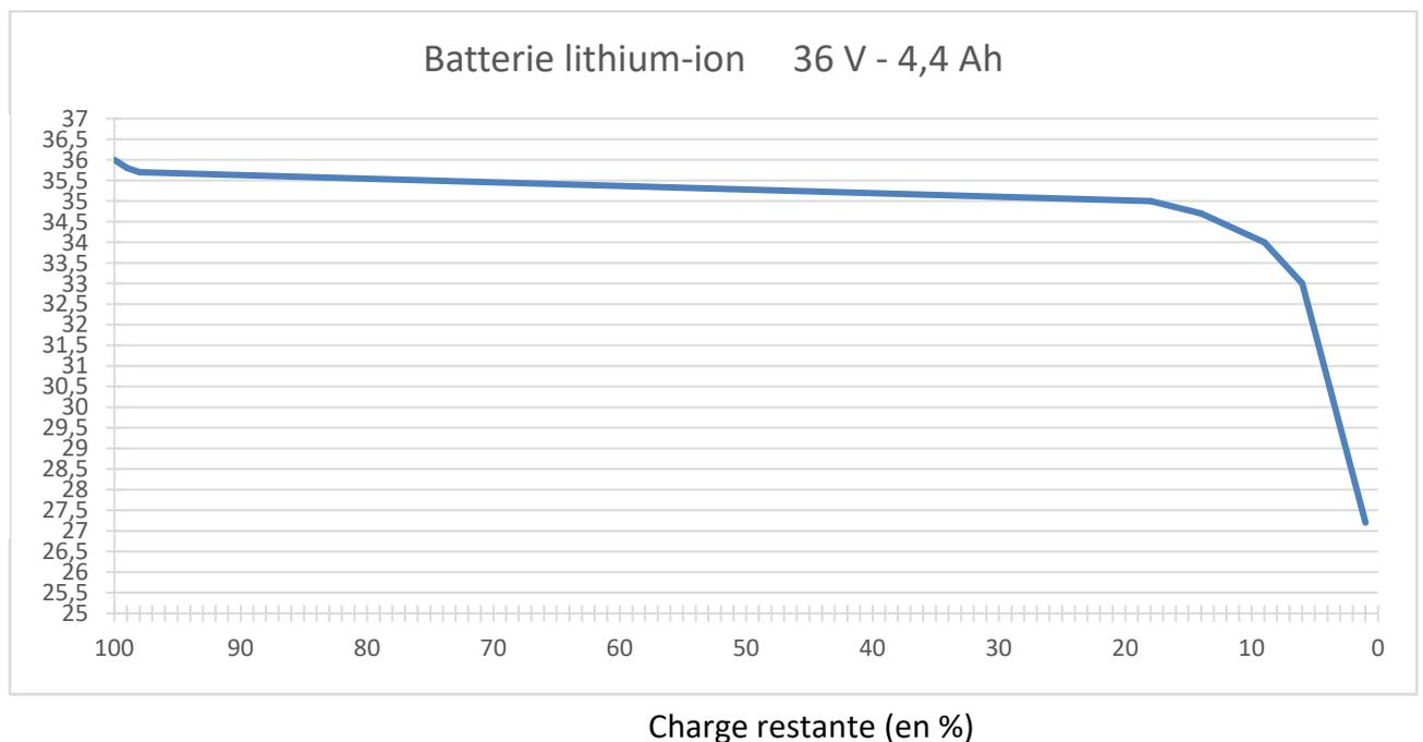
Fig.3 courbe de décharge de batterie
