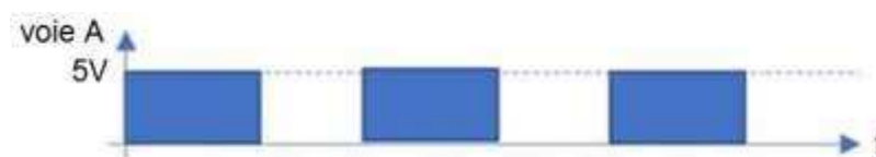
Figure 9 : signal en créneau délivré par le capteur lors de la rotation de la roue
