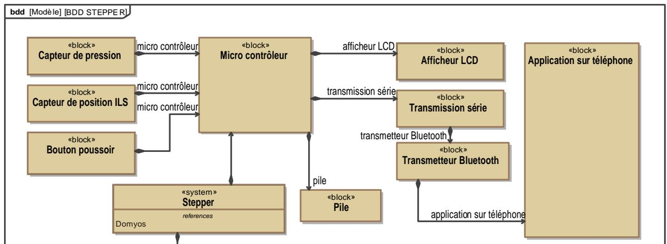
Figure 1 : diagramme de définition des blocs
