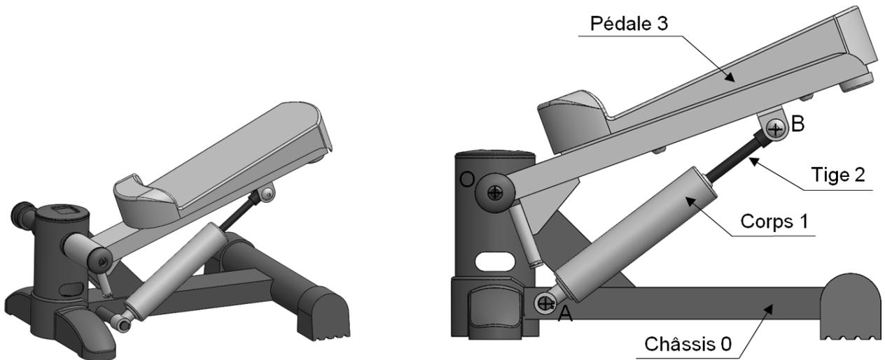
Figure 2 : principaux éléments du stepper
