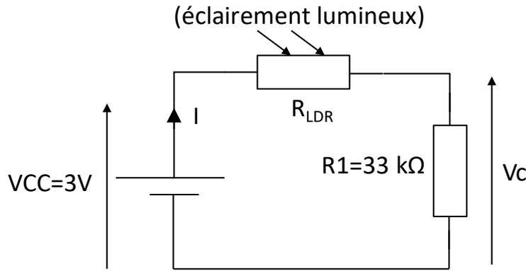
Figure 2.b : montage capteur
