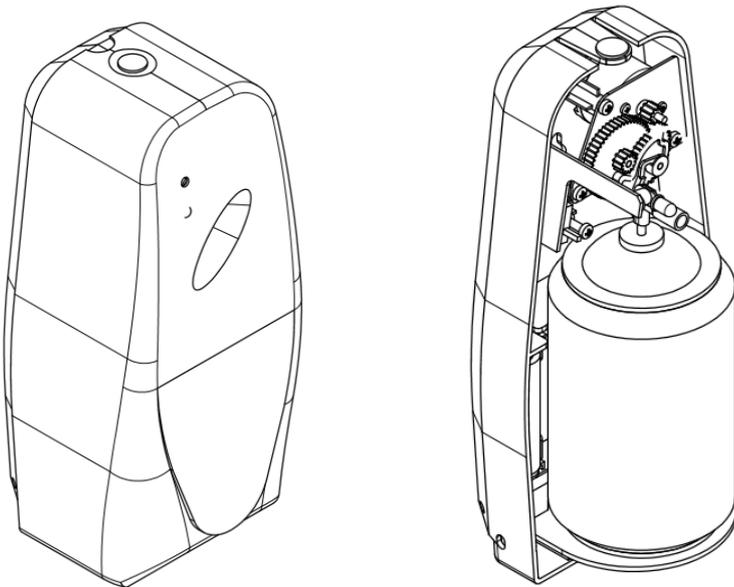
Figure 1.a : vues du diffuseur avec et sans capot
