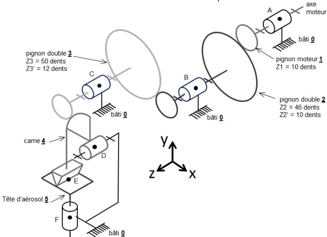
Figure 1.e : schéma cinématique du système de diffusion
