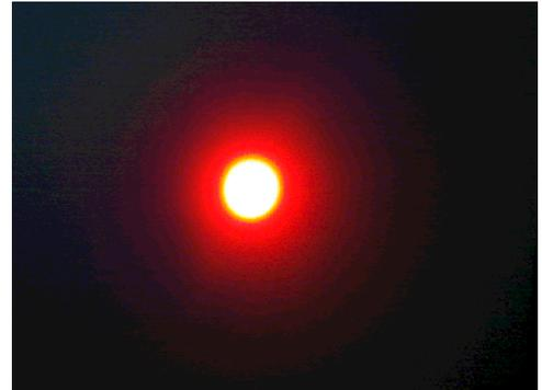
Faisceau laser après épuraison. L'observation ou la mesure montrent que la répartition de l'intensité est beaucoup plus homogène (voir TP 'filtrage des fréquences spatiale')
