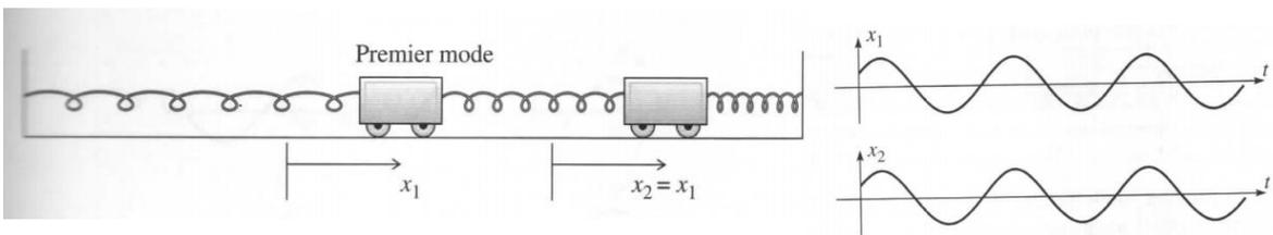
Figure 1 : 1<sup>er</sup> mode propre
