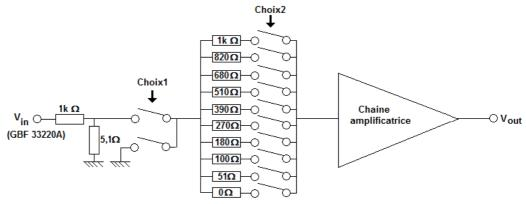
Le choix 1 permet soit d'appliquer la tension atténuée d'un générateur d'entrée (rapport 5,1/1005,1 environ pour éviter les saturations en sortie) afin d'obtenir le diagramme de Bode de la chaîne amplificatrice pour chaque valeur de résistance de bruit, sélectionnées par « choix2 », soit de mettre l'une des borne des résistances bruyantes à la masse, le « choix2 » permettant de choisir cette résistance.
