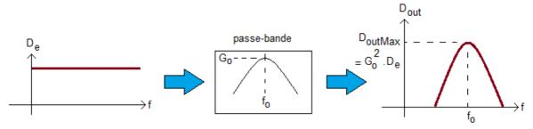
Il suffit donc de connaître précisément le gain maximum  $G_o$  du filtre passe-bande qui réalise l'amplification, la densité spectrale maximale du bruit de sortie  $D_{outMax}$  pour la résistance R et  $D_{outMax(R=0)}$  obtenue quand l'entrée est en court circuit (sans résistance) et on connaît la densité spectrale de puissance  $D_b$  du bruit associé à la résistance R étudiée par
