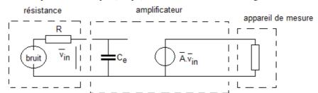
On note que la valeur de résistance que l'on veut caractériser aura une légère influence sur la bande passante de l'amplificateur, à cause de la capacité d'entrée de ce dernier, importante sur les circuits à FET. Si on cherche la bande équivalente de bruit de l'amplificateur, il faudra donc le faire pour chaque valeur de résistance étudiée.
