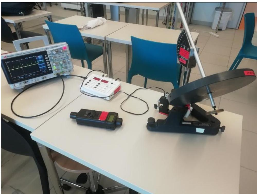
Fig. 2 – Montage gyroscope déséquilibré
