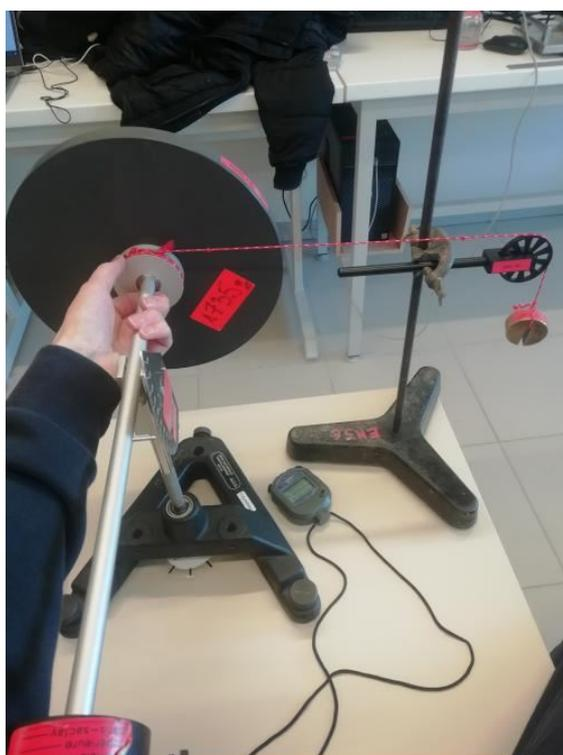
Fig. 1 – Montage moment d'inertie
