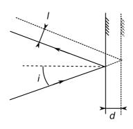
Comme on le voit sur le schéma ci-dessus, une translation du bloc mobile entraine un déplacement latéral du faisceau réfléchi, détecté par la photodiode à cadrans.
