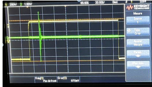
Fig. 2 – Visualisation à l'oscilloscope du signal reçu par le récepteur (signal vert).
