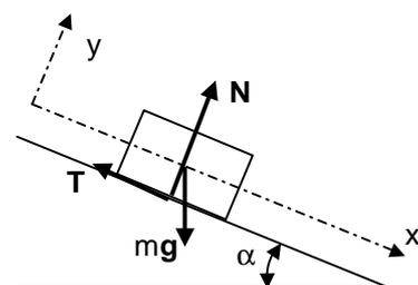
et puisque le solide est immobile  $T/N = \tan \alpha \leq \mu_S$ . C'est le phénomène d'arc-boutement. Quelle que soit la masse du solide, il ne glisse pas tant que  $\alpha \leq \alpha_S$  avec  $\tan \alpha_S = \mu_S$ . Ceci explique aussi que l'on ne peut pas enfoncer une visse en appuyant simplement dessus (même avec un marteau !) car l'inclinaison des filets n'est pas suffisante pour autoriser le glissement.
