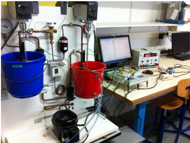
Pompe à chaleur avec dispositif d'acquisition
