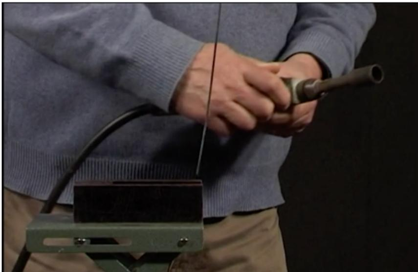
Figure: Processus de désaimantation d'un morceau de fer.
