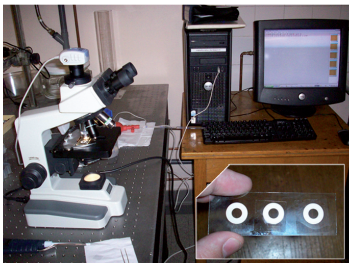
Figure 1 : Dispositif expérimental : la caméra du microscope est reliée par port USB sur l'ordinateur. En encart : une cuve réalisée avec un œillet collé sur une lame de microscope et recouvert d'une lamelle.
