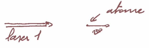
L'atome absorbe un photon du laser 1 et l'impulsion du photon est transférée à l'atome. La nouvelle vitesse de l'atome est alors  $\vec{v} + \frac{\hbar \vec{k}_{abs}}{m}$ . L'atome va émettre
