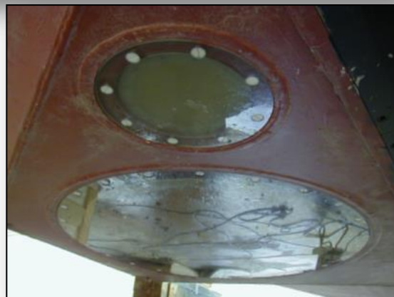
Bases 38 kHz et 150 kHz après mise en place des fenêtres acoustiques
