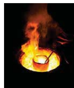
Platine en fusion. Adopté en 1889 comme nouvelle référence photométrique
