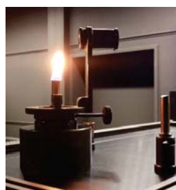
Lampe de Hefner (1884) permettant d'obtenir une flamme contrôlée
