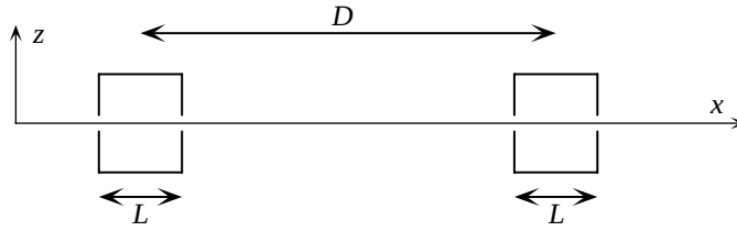
FIG. 17.4: Dispositif pour l'observation des franges de Ramsey.
