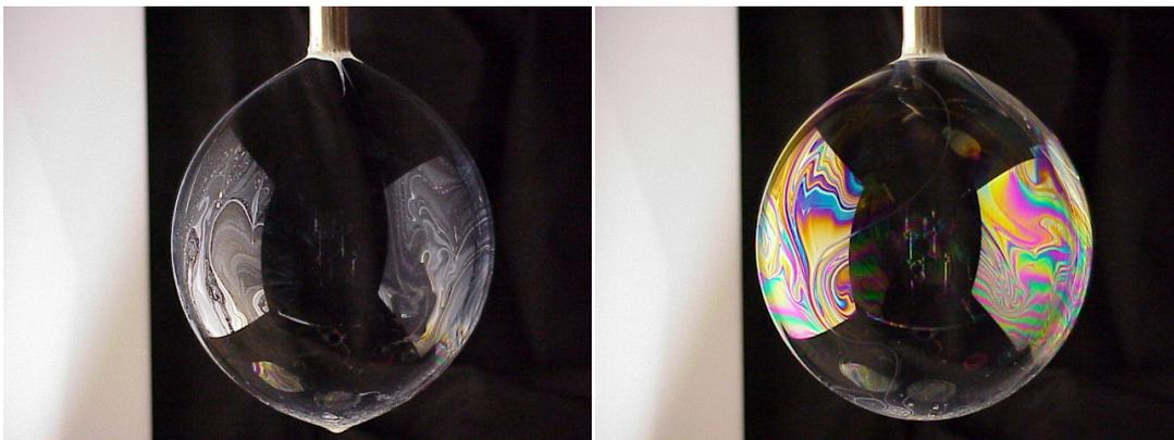
Franges d'interférence obtenues par réflexion de lumière blanche sur une bulle de savon. Cet exemple illustre comment des interférences permettent des mesures précises et en temps réel.
