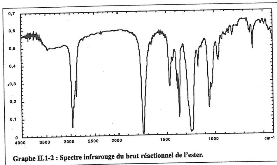
Graphique II.1-2 : Spectre infrarouge du brut réactionnel de l'ester.
