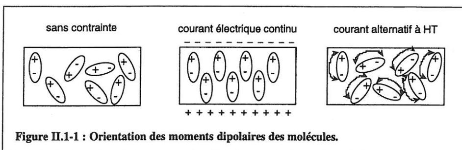
Figure II.1-1 : Orientation des moments dipolaires des molécules.
