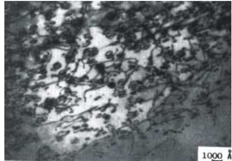
boucles de contournement d'Orowan dans un alliage Al-Li vieilli 26
