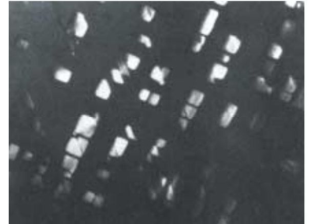
précipités cisailés par fatigue dans un alliage Ni-15%Al
