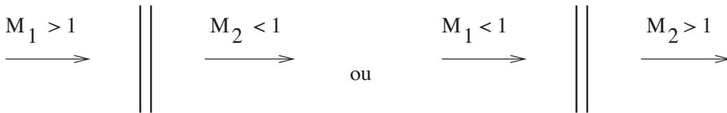
FIGURE 3.3 – Configurations d'écoulements *a priori* possibles de part et d'autre d'une onde de choc 1D
