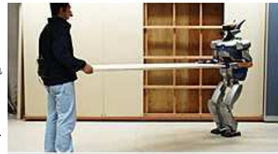
FIGURE 2 – Quand on tient HRP-2 par les mains ou par le biais d'un objet, on ressent les à-coups...
