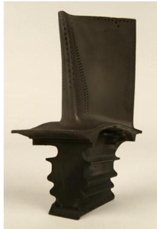
Aube de turbine en superalliage monocristallin utilisée dans un moteur d'avion Pratt & Whitney résistant jusqu'à 1000° C.
