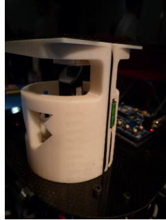
La tourelle Microb de 2009 (c'est un capteur IR, pas un laser !)
