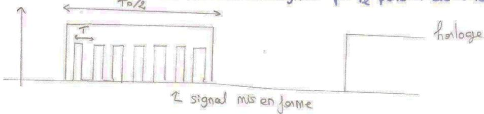
monter : le signal d'horloge à l'oscillo, et qu'en changeant de calibre on multiplie (ou divise) la fréquence par 2 à chaque fois.
