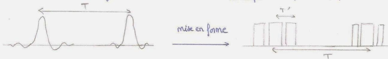
Et la méthode repose sur la mise en forme du signal étudié : il faut qu'il y ait un seul zéro par période pour compter la "vraie" fréquence. Une sinusoïde trop bruyée aura une mise en forme ayant des passages par zéro intempestifs et dc on mesurera une fréquence trop élevée.
