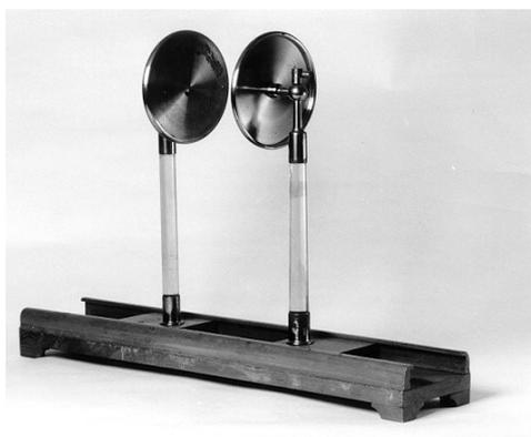
On branche un LC-mètre sur les plaques du condensateur et on mesure la capacité pour différentes distances entre les deux plaques.
