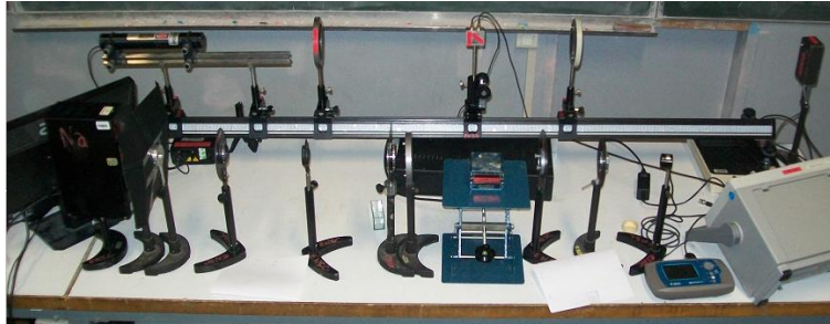
FIGURE 7 – Effet Pockels derrière le montage pouvoir rotatoire, montage utilisé pour faire les mesures
