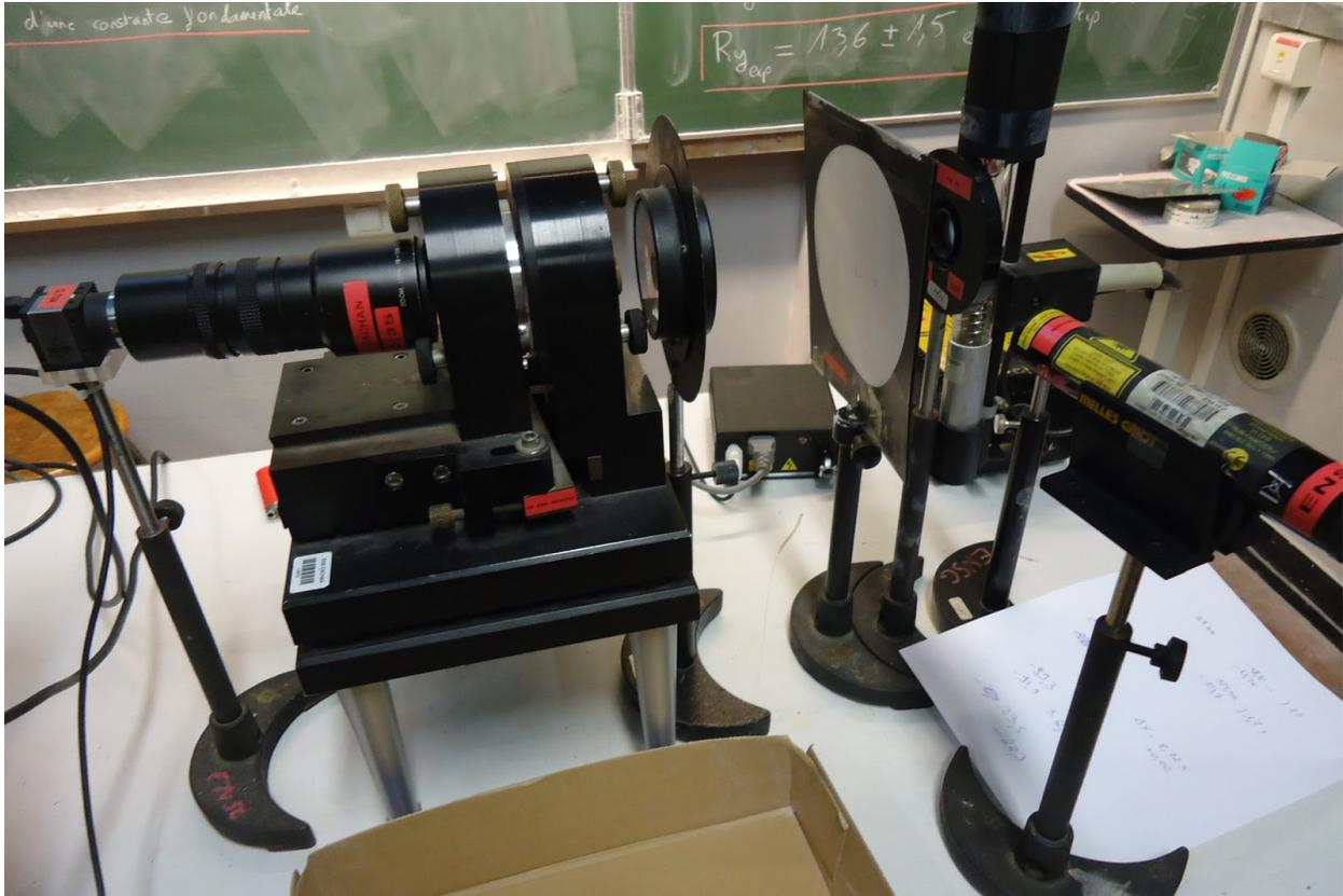
Le diffuseur est important car la lampe à hydrogène n'est pas très puissante, du coup sans diffuseur, en regardant dans la Fabry perot on voit juste le filament. De plus, il est utile pour réaliser la référence (cf principe de la mesure) en envoyant un laser en biais sur le diffuseur.
