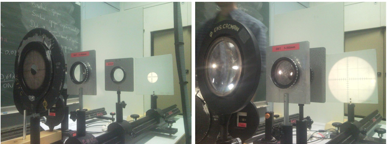
FIGURE 15 – A gauche, l'influence du diaphragme de champ. A droite, l'influence du verre de champ : le champ est doublé car on observe 4 \times 4 carreaux, mais le grossissement n'a pas changé.
