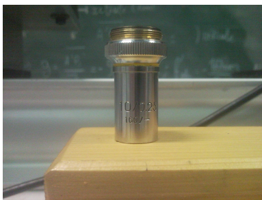
FIGURE 34 – Objectif fabriqué pour faire la microscopie à fond noir.
