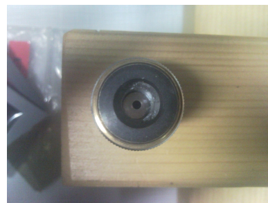
FIGURE 34 – Objectif fabriqué pour faire la microscopie à fond noir.
