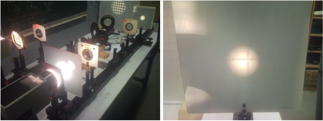
FIGURE 10 – A gauche, le montage objet à l’infini et oeil fictif. A droite, l’image observée.
