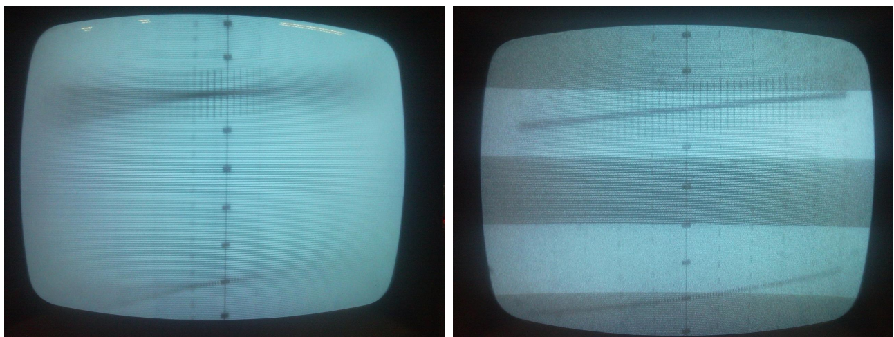
FIGURE 9 – A gauche, le diaphragme d'ouverture est ouvert au maximum et l'image a une faible profondeur de champ. A droite c'est l'inverse, mais la luminosité de l'image a baissé.
