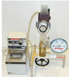
FIGURE 1 – Dispositif d'études d'isothermes de SF6.
