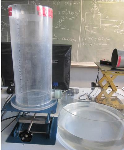
Pas de bouchon, on a ajouté un robinet afin de fermer la sortie pour le remplissage. Lors du remplissage, remplir au delà de la graduation 0 (il est difficile d'enlever le robinet et démarrer le chronomètre en même temps...). On retire ensuite le robinet pour la mesure de  $\sqrt{h}$  fonction du temps, en déclenchant un chronomètre lorsque le niveau passe sous le 0. Il vaut mieux retirer le robinet que l'ouvrir, ça fonctionne mieux (cf courbes ci dessous).
