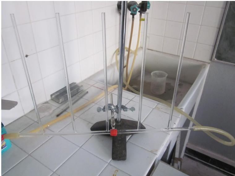
Pour la perte de charge, ça marche bien en injectant de l'eau avec un robinet et les manomètres vers le haut. On vérifie que les hauteurs d'eau s'alignent suivant une droite. Coefficient directeur devrait être égal à  $\rho g \frac{\pi d^4}{128 \nu D_m}$  donc diminue lorsque l'on augmente le débit. L'ajout d'un fond noir peut rendre la manip plus visible.
