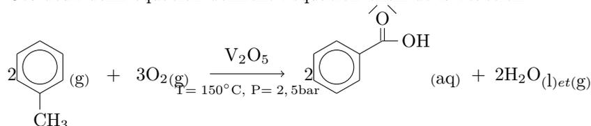
Cette réaction est effectuée dans un réacteur maintenu à une température de 150°C et une pression de 2,5 bar, et en présence d'un catalyseur : le pentoxyde de vanadium V<sub>2</sub>O<sub>5</sub>.
