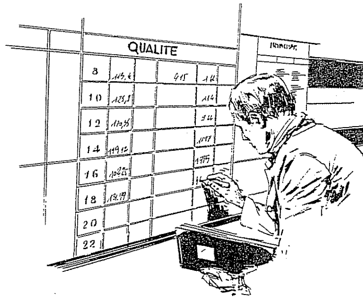
Fig. 5-8 - Usine Renault de Sandouville. Sur la ligne de montage, l'indice qualité est mesuré régulièrement par audit d'un véhicule prélevé en bout de ligne. Toutes les deux heures, un agent vient inscrire sur un tableau les données relatives à ce qui a été produit dans l'unité (c'est-à-dire dans une section de montage qui regroupe environ vingt personnes). Ainsi, chaque monteur voit immédiatement si l'unité à laquelle il appartient a fait du bon travail.
