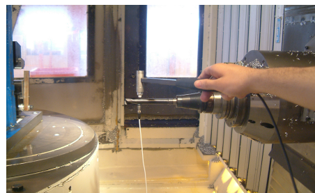
FIG. 4.6 – Essai au marteau de choc [Gag06].
