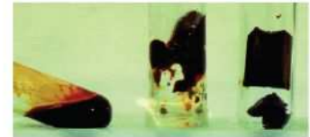
Transition fluide-solide dans un ferrofluide (G. Mériquet, thèse)
