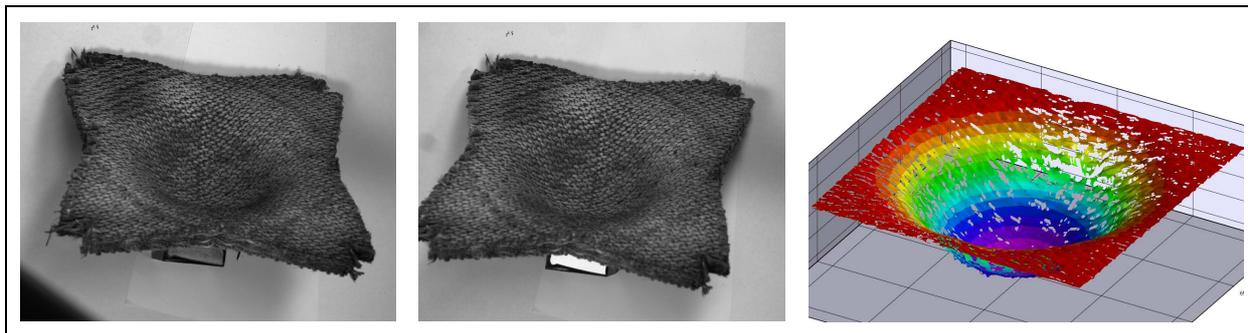
Figure A-8 : Stéréo corrélation sur une éprouvette emboutie
